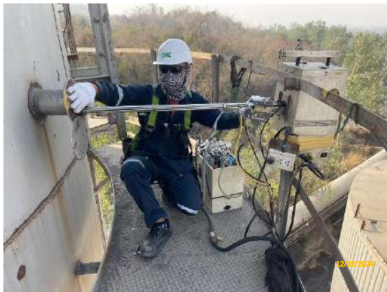
ปล่องระบายของหม้อไอน้ำ 200 ตันต่อชั่วโมง Boiler 200 Tons (กรณีพ่นเขม่า (Soot Blow))
